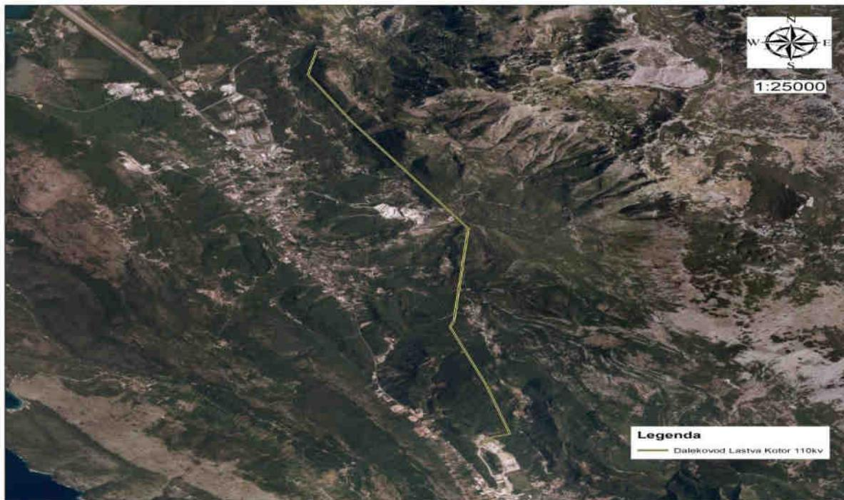
Slika 3.27 Novi 110 kV dalekovod Lastva - Kotor
